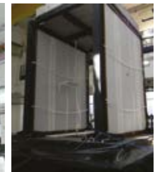
Pareti in forati testate su tavola vibrante - al termine della prova
