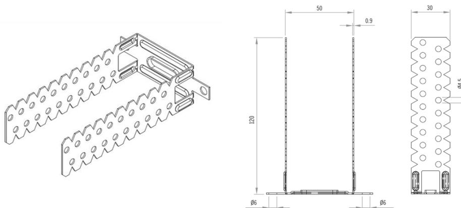
Il prodotto fa parte di un sistema di controsoffitto assemblato con prodotti a marchio Siniat. I valori di carico ammissibile si riferiscono all'assemblaggio di "Staffa registrabile 120x50", profili "PregyMetal S4915/27 BA/BS" e viti "Teks SNT".
