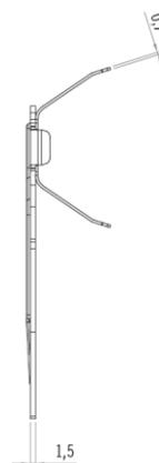
Il prodotto fa parte di un sistema di controsoffitto assemblato con prodotti a marchio Siniat. I valori di carico ammissibile si riferiscono all'assemblaggio di "Gancio con molla scorrevole", "Pendino liscio  $\Phi$  3,9 mm" e profili "PregyGrid T24/37" o "PregyGrid T15/37".
