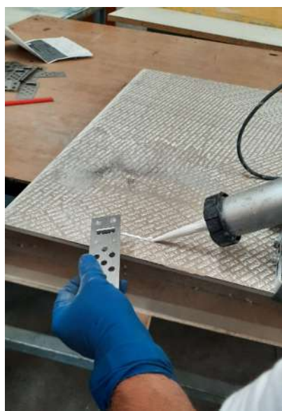
Posizionamento ganci RAI-FIX sul retro delle piastrelle
