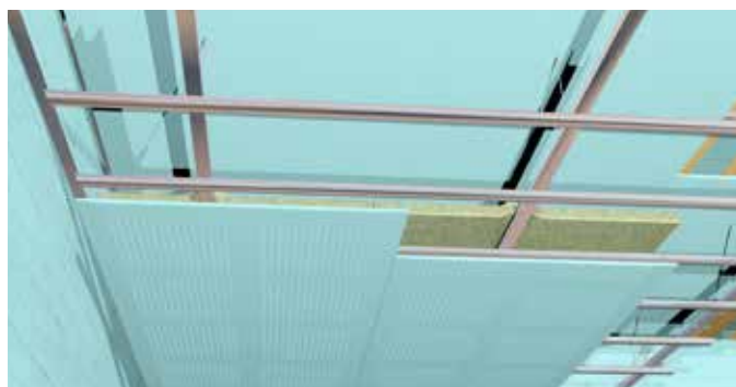
Figura 36 - Schema montaggio del controsoffitto fonoassorbente.
