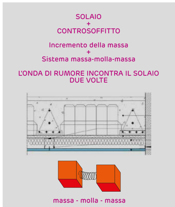
Fig. 34 - Principio di funzionamento del controsoffitto
