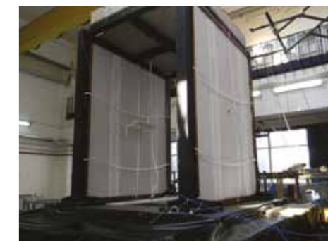
Prova di pareti a secco su tavola vibrante
