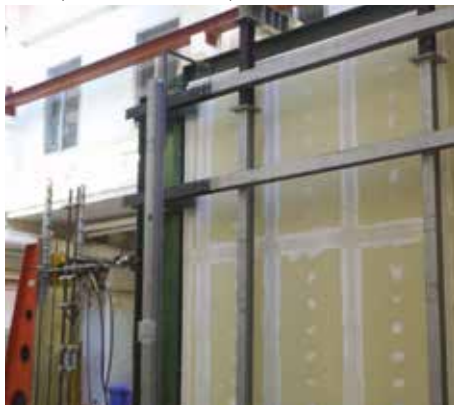
Test quasi-statico nel piano
