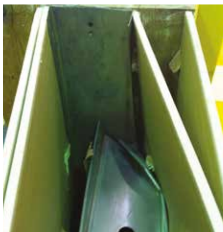
Prove fuori piano - Espulsione delle lastre e dei montanti dalla guida
