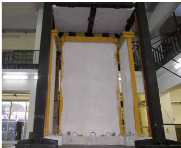
Pareti in forati testate su tavola vibrante - Prima della prova
