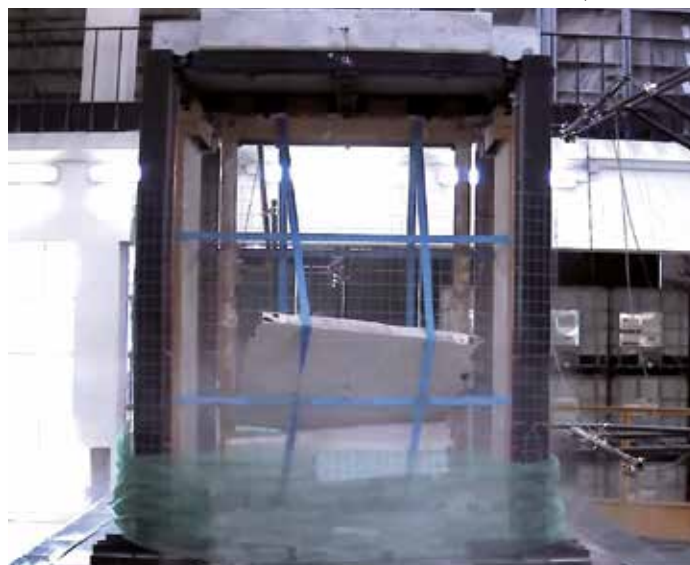
Pareti in forati testate su tavola vibrante - Al termine della prova
