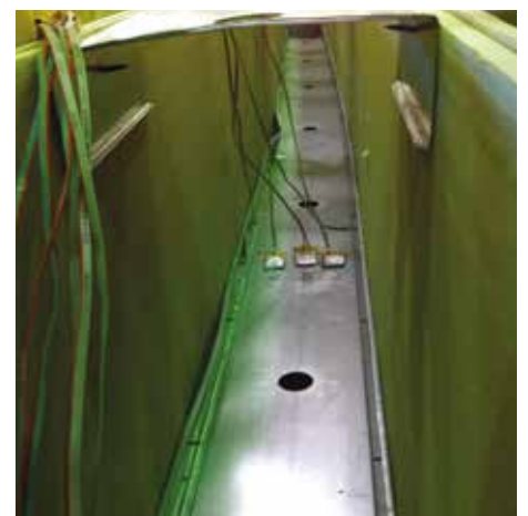
Prove fuori piano - Instabilità locale delle ali dei montanti
