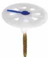
Non sono necessari fissaggi meccanici secondari, ma può essere richiesto di rafforzare i pannelli isolanti in corrispondenza delle aperture e delle finestre. L'eventuale fissaggio meccanico supplementare deve essere eseguito, in corrispondenza della struttura metallica, attraverso la lastra, utilizzando un fissaggio in nylon con vite acciaio zincato.
