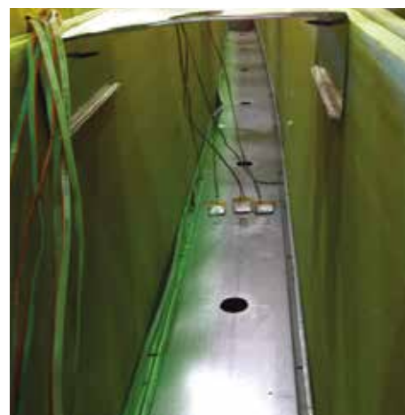
Prove fuori piano - Instabilità locale delle ali dei montanti
