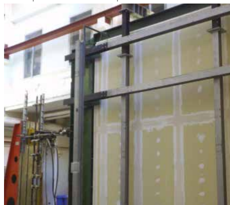
Test quasi-statico nel piano
