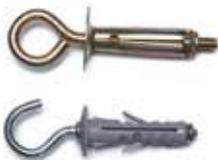
I **ganci a X** e i **tasselli in plastica ad espansione** consentono di sostenere **carichi inferiori a 10 kg per punto di fissaggio**. Il mercato offre altre tipologie quali i tasselli in nylon ad avvitatura diretta: sono tutti utilizzabili ma con l'accorgimento del rispetto dei carichi massimi applicabili sopra indicati.
