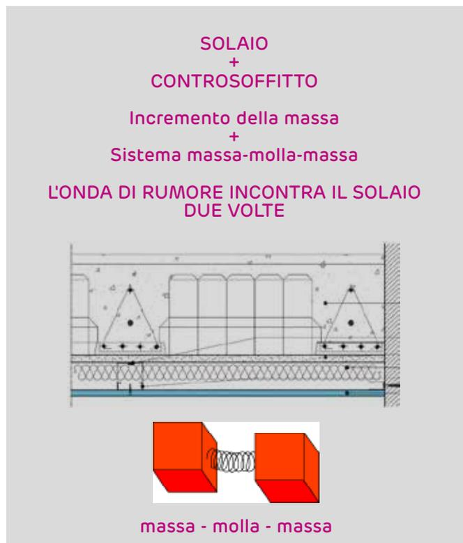
Fig. 34 - Principio di funzionamento del controsoffitto
