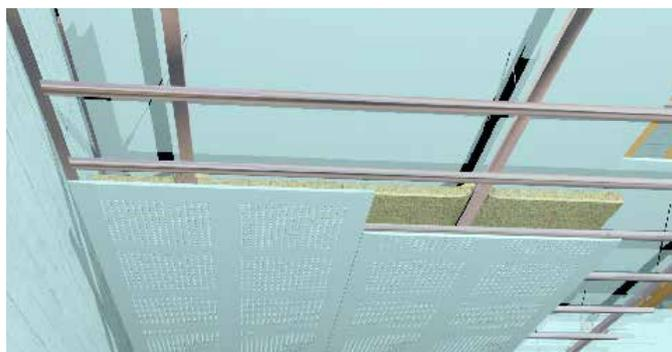
Figura 36 - Schema montaggio del controsoffitto fonoassorbente.
