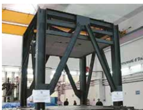
Prova di controsoffitto su tavola vibrante
