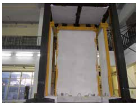
Pareti in forati testate su tavola vibrante - Prima della prova
