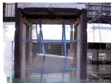
Pareti in forati testate su tavola vibrante - Al termine della prova
