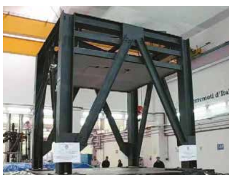
Prova di controsoffitto su tavola vibrante
