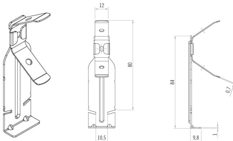
Il prodotto fa parte di un sistema di controsoffitto assemblato con prodotti a marchio Siniat. I valori di carico ammissibile si riferiscono all'assemblaggio di "Gancio con molla per Guida Clip", "Pendino liscio  $\Phi$  3,9 mm", profili "Guida Clip" e "PregyMetal S4927 BA".
